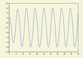
Comme nous pouvons le constater la solution déterminée tend vers un *cycle limite* dans l'espace des phases, elle devient quasimément *périodique*. C'est la cas, pour la valeur de *c* choisie ici, quelles que soient les conditions initiales.
